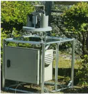
校門正面に設置された雨量計
