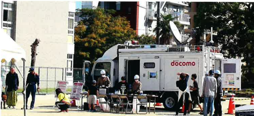
NTT ドコモの衛星基地局車展示。災害時の通信不能の携帯エリアをスポット救済可能。ケイタイ電話の充電などができる
